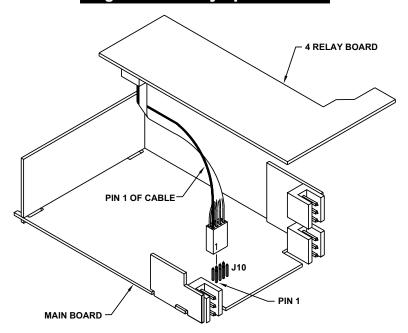
Figure 5-9. 4-Relay Option Board
