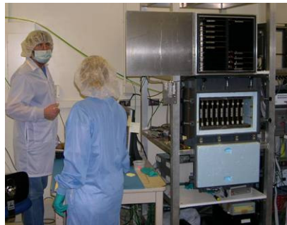
Thermal test module
