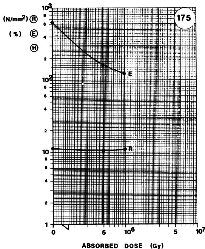
**MATERIAL:** PE**TYPE:** PE/315/PVC**SUPPLIER:** BICC**Remarks:** VIDEO CABLE VAU 24 (UNDER-GROUND TYPE)
