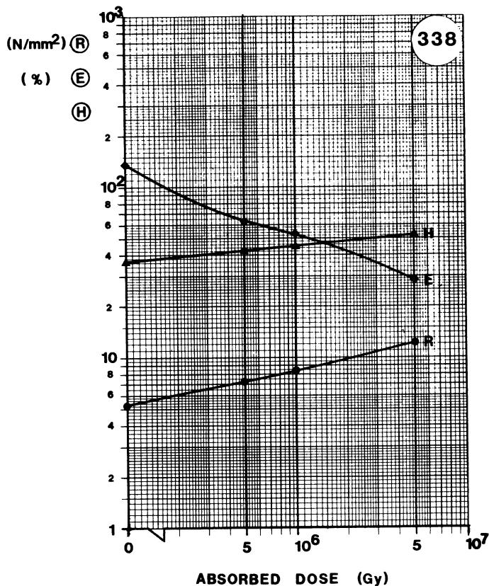
**MATERIAL:** EPDM**TYPE:** BASIS EPDM-PE, JACKET**SUPPLIER:** DÄTWYLER**Remarks:**
