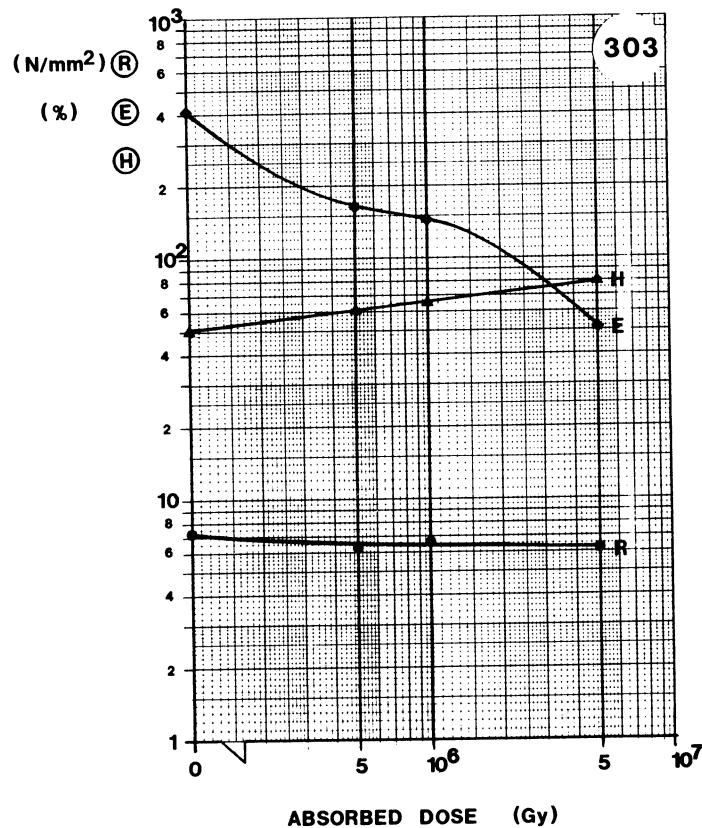
**MATERIAL:** EPDM**TYPE:** NORDEL, INSULATING COMPOUND**SUPPLIER:** DOLDER**Remarks:**
