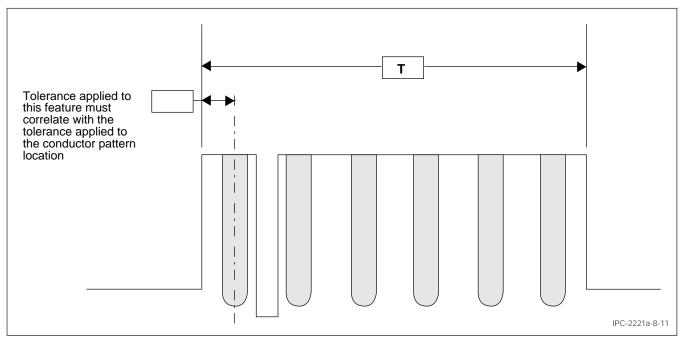
Figure 8-11 Board Edge Tolerancing
